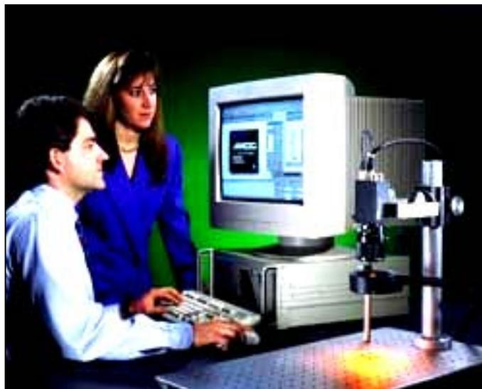
Figura 2.5. Iluminación con lámpara circular para un sistema de inspección
