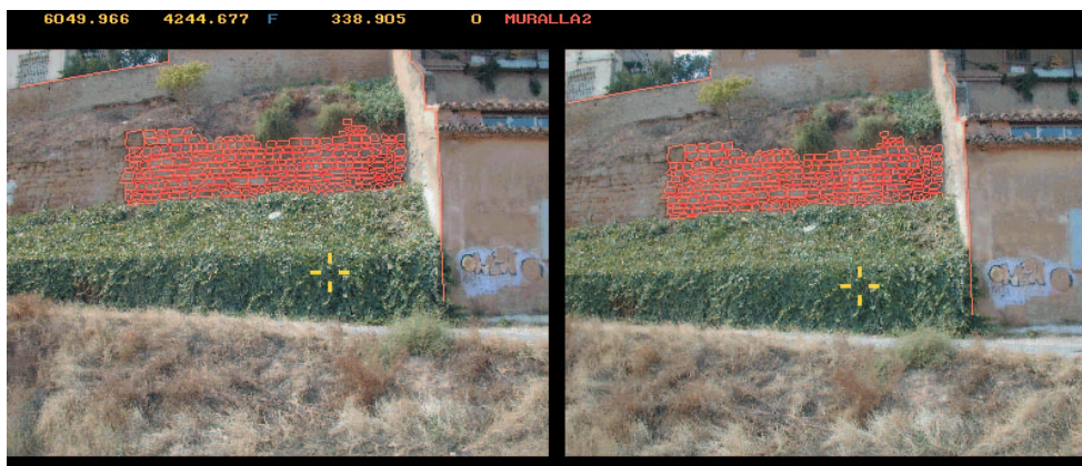
Figura 5. Proceso de restitución fotogramétrica
